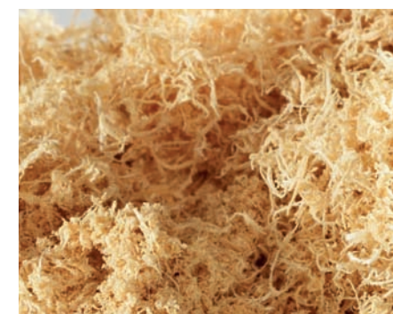
Pył powstały podczas szlifowania materiałami konkurencji zdecydowanie zawiera wyrwane włókna.
